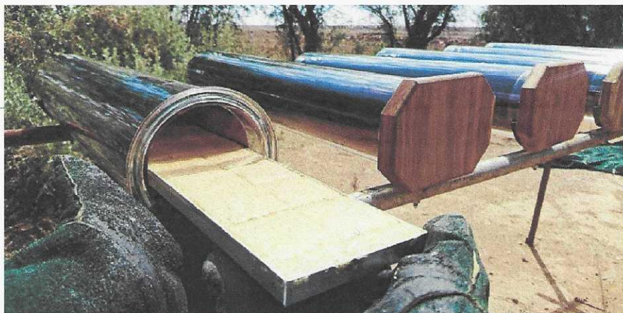
Die nuwe glassonbuisoond waarmee brood selfs in 70% bewolkte weer gebak kan word.
